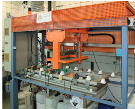
Bilder: TU Ilmenau Technikumsanlage an der TU Ilmenau zur automatisierten Chrom(III)-Beschichtung
