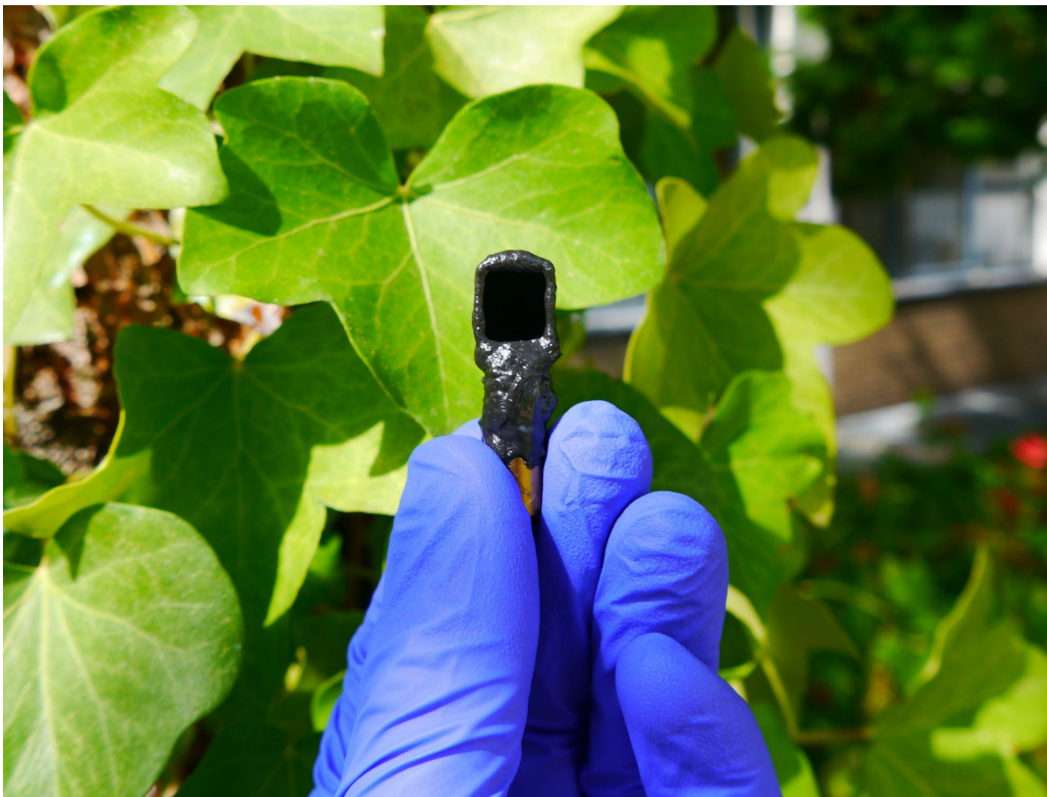
Bild 2: Die kleine Zelle wandelt rund 14 % der einfallenden Solarenergie in Wasserstoff um
