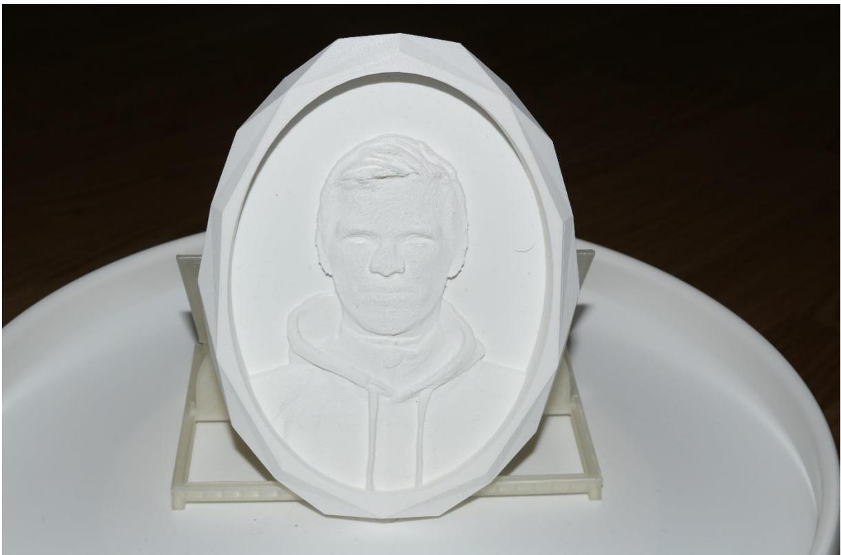
Ergebnis eines Kurses – 3D Druck von einem Höhenprofil aus einem Bild. Dies kann es blinden Leuten ermöglichen Bilder zu „fühlen“.
