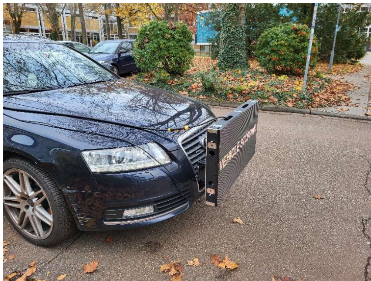
Abbildung 7: Verzerrung der angezeigten Nachricht bei Betrachtung von der Seite
